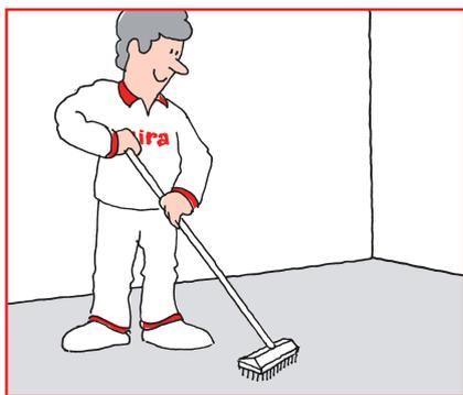
Нанести грунтовку на основание с помощью щетки/кисти. Равномерно распределить по всей поверхности. После высыхания грунтовки (через 1-2 часа) можно применять самовыравнивающую смесь.
