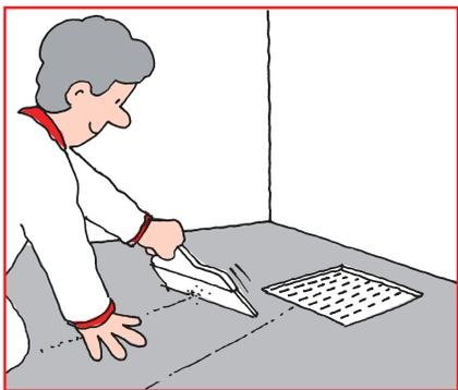
После нанесения смеси ее можно выравнять в течение приблизительно 20 минут.
