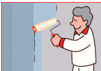
Грунт mira 5335 quartz grund или mira 5408 silikat grund наносится на поверхность валиком для краски.
